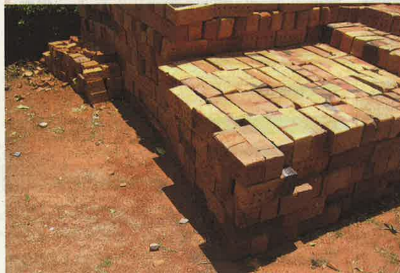
In Afrika üblich: das Bauen mit handgemachten Ziegeln aus dem Lehm des Baugrundstücks. Foto: Prof. Susanne Runkel
