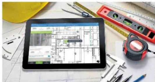
Baumängelmanagement per Tablet: Per Mausclick wird der Mangel definiert und einer verantwortlichen Person zugewiesen.
