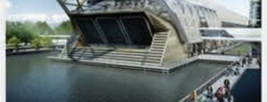
— Crossrail-Station in London: Das Oberdeck dieser Bahnhaltestelle wird von einer Gitterkonstruktion in Holzbauweise mit Membrankissen tonnenförmig überdacht.
